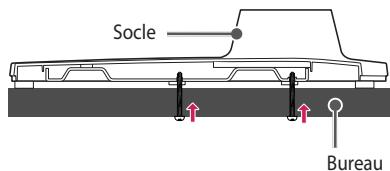
Vis : M5 x L (\* L : profondeur de la table + 8 à 10 mm)
