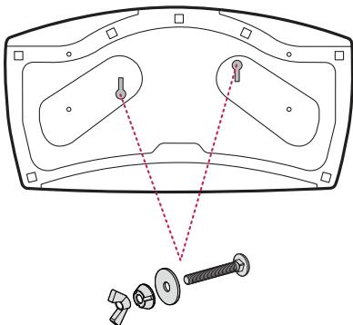
2 vis pour la fixation du socle,
