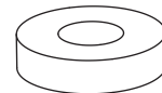
14. Plastic Washer \Phi 25 \times \Phi 11 \times 6 (2) Rondelle en Plastique \Phi 25 \times \Phi 11 \times 6 (2) Arandela de Plástico \Phi 25 \times \Phi 11 \times 6 (2)
