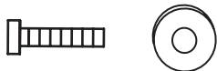
M8*40 Back Leg Screw Vis pour la Patte Arrière Tornillo de la Pata Trasera
